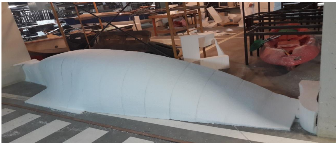
Fig. 13 - Realização do molde em esferovite
